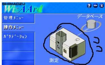
点検リストが表示される。(3)のグラファイトチューブの加熱回数が、使用ノートの前回使用者の数字と一致しているかを確認する。
