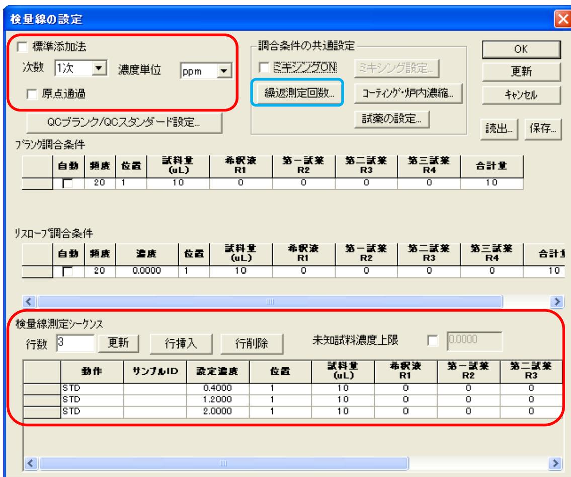
必要な情報を入力する。主に入力が必要なのは図の二か所。行数（検量線用試料の数）、設定濃度、位置（オートサンプラー）の指定は必須。（赤枠）繰返測定回数を変更したい時もこの画面から。（青枠） 入力が終わったら「OK」をクリック。
