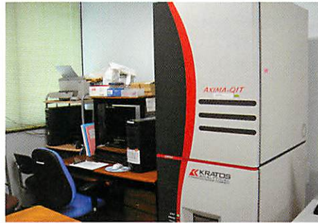
レーザーイオン化 4重極イオントラップ 飛行時間型 質量分析装置
