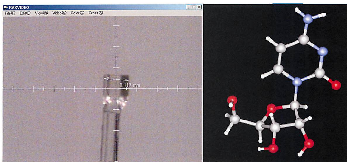
図 1 左) 単結晶 X 線構造解析用の単結晶試料 (0.15 mm × 0.12 mm × 0.12 mm) 右) 得られた解析結果 試料: cytidine C 9 H 13 N 3 O 5
