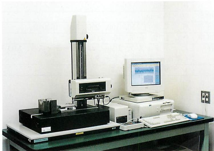
Fig. 2 表面粗さ測定器
