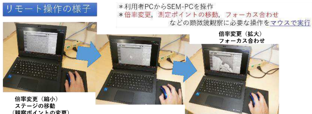
図 4 SU9000 の遠隔操作（リモート操作）モード概要
